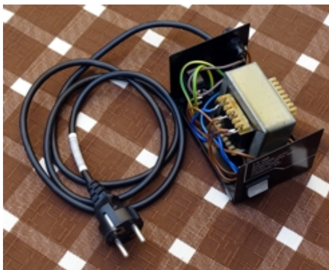
Obr. 3 - Vnitřek převodního trafa CV 100
