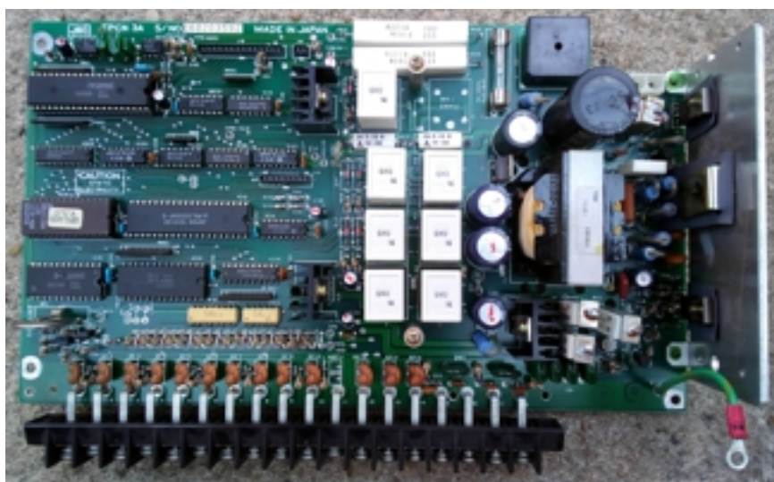
Obr. 6 - Elektronika původního ovládání NITEC EPS-103
